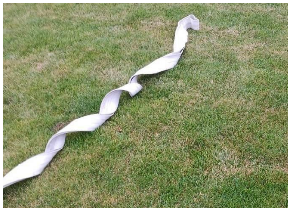
Fig.33a : Tuyau de pression mal conçu
