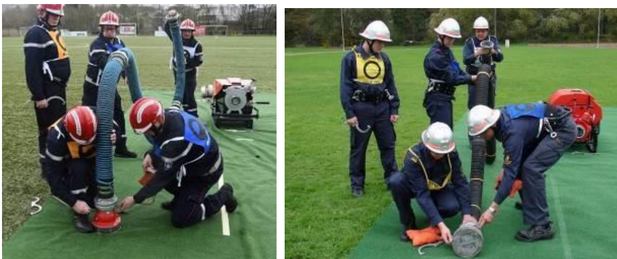
Fig.21/21a : Soulever le tuyau d'aspiration couplé, mettre en place le tuyau d'aspiration et accrochement des cordes de tuyaux et du clapet à la crépine.
