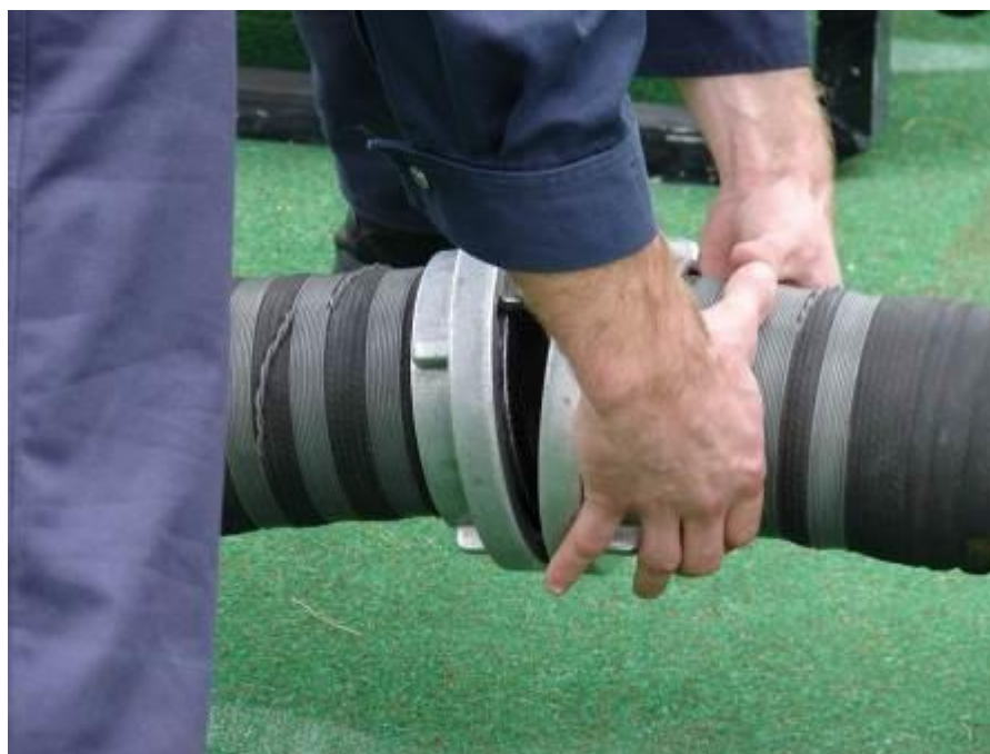
Fig.16b : Seul le tuyau d'aspiration à raccorder peut-être touché par l'équipier de tuyau STRM.
