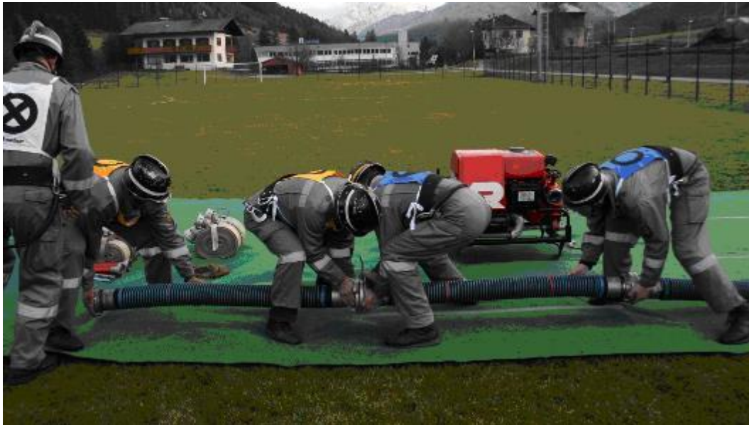
Fig.17 : Le machiniste MA supervise le raccordement de la conduite d'aspiration par l'équipe d'eau WTR et l'équipe de tuyau STR.
