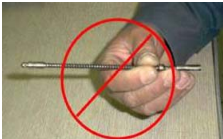
РИС. 8. Весьма опасный источник из радиографической камеры (никогда не следует брать в руки).
